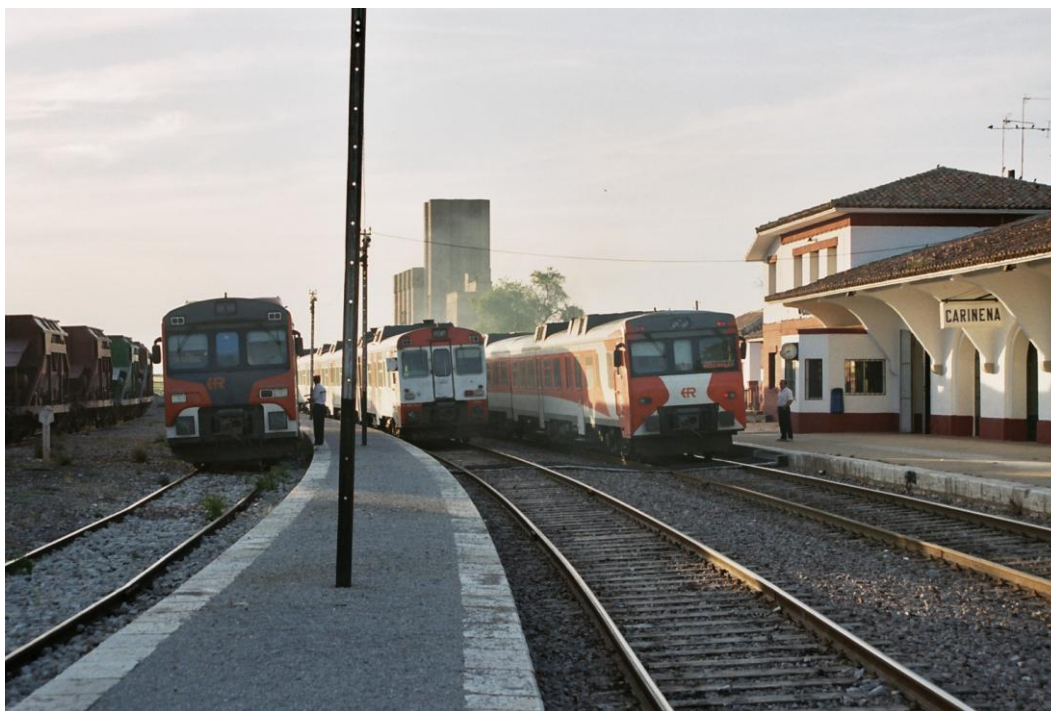
La variedad de automotores que han circulado en la línea Zaragoza-Valencia en los últimos años se refleja plenamente en esta imagen en donde coinciden en la estación de Cariñena tres series diferentes de automotores. De derecha a izquierda, en la vía I MAN s/592.200 del regional Valencia-Huesca, en la vía II un FIAT s/593 sin servicio y en la vía III un FIAT s/596 prestando servicio al regional Zaragoza-Teruel. Cariñena 28 de mayo de 2003.
