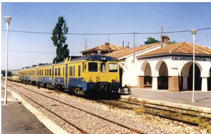
Aspecto inicial del esquema de pintura de los automotores MAN s/592, que mantuvieron hasta la creación de las Unidades de Negocio. En la imagen tren regional Zaragoza- Valencia nº 2541 estacionado en Calamocha-Nueva el día 18 de julio de 1991. Foto: Jesús Carballo
